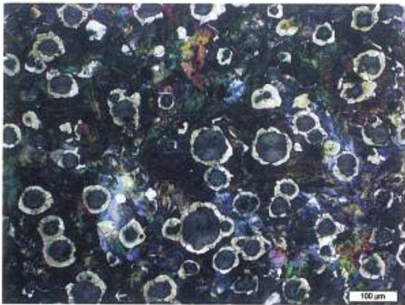
รูปที่ 6 โครงสร้างทางจุลภาคหลังการกัดกรวด (Nital 2%) พบกราฟไฟต์ชนิดที่อ่อนกมลกระจายตัวอยู่ในชิ้นงาน โดยมีโครงสร้างพื้นฐานหลักเป็นโครงสร้างเฟอร์ไรต์และโครงสร้างเพอร์ไรท์ล้อมรอบกับกราฟไฟต์
