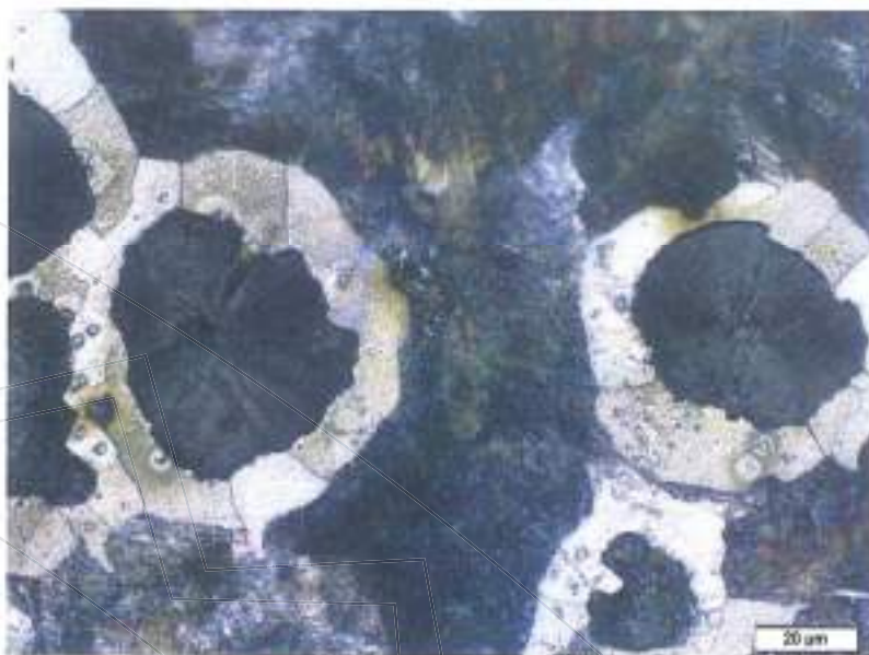
รูปที่ 8 โครงสร้างทางจุลภาคหลังการกัดกรด (Nital 29%) พบกราฟไฟต์ชนิดก้อนกลมกระจายตัวอยู่ในชิ้นงาน โดยมีโครงสร้างพื้นฐานหลักเป็นโครงสร้างเฟอร์ไรต์และโครงสร้างเพอร์ไรท์ล้อมรอบก้อนกราฟไฟท์
